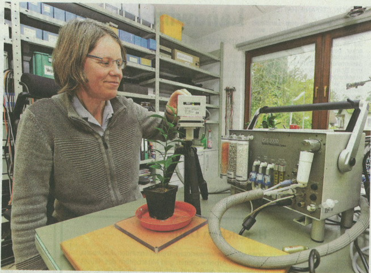
Die Biologin Katharina Siebke demonstriert ein Walz-Messgerät. Diese zeigen anhand der Photosynthese den Stresslevel von Pflanzen. Für ihre Handwerkskunst erhielt die Heinz Walz GmbH nun den Bayerischen Exportpreis. Foto: Mark Johnston
